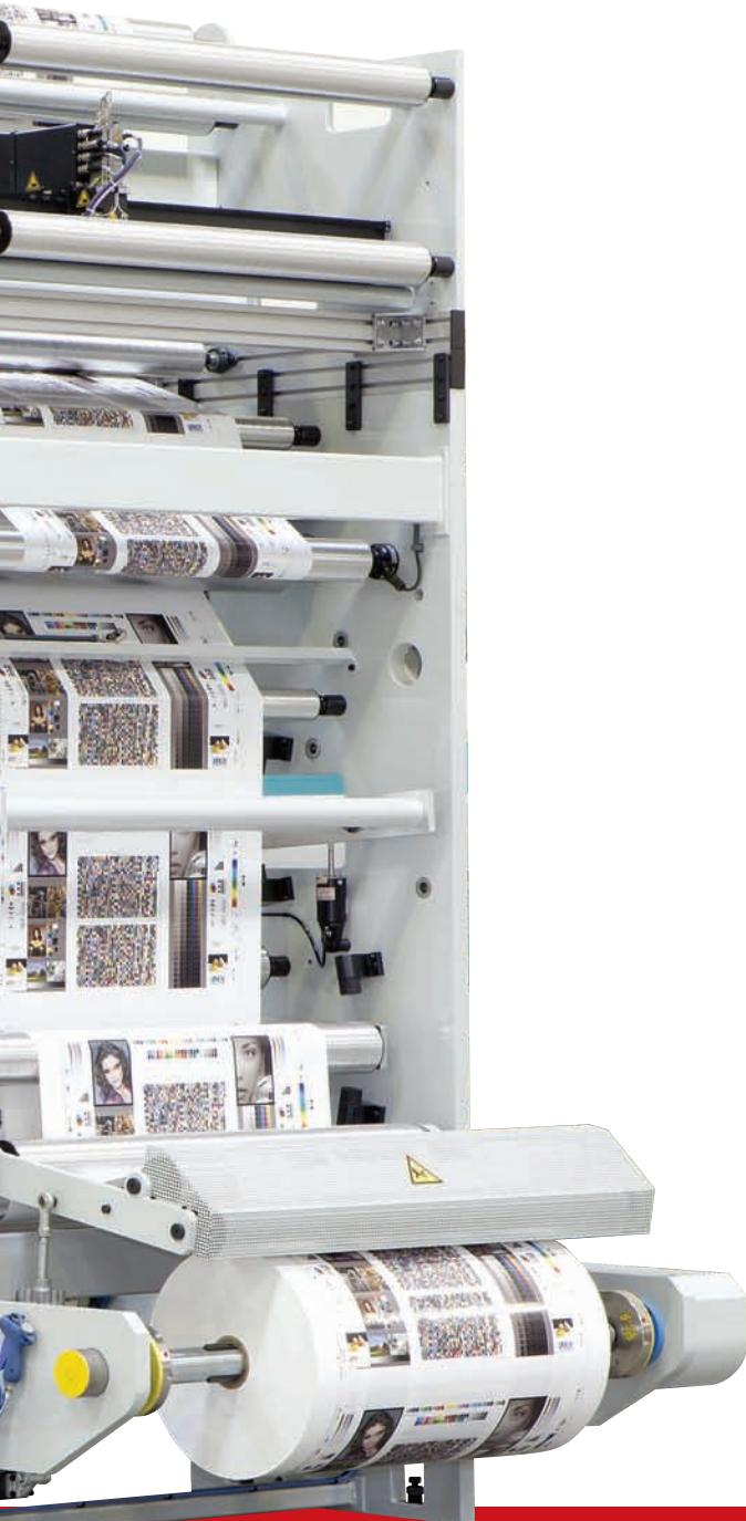
**Grupos impresores** equipados con transmisión por servomotores, sistema de pre-posicionamiento de registro longitudinal, cambio de camisas porta-clisés y anilox tipo "cantilever", rasquetas a cámara cerrada y rotación lenta motorizada del rodillo anilox.
